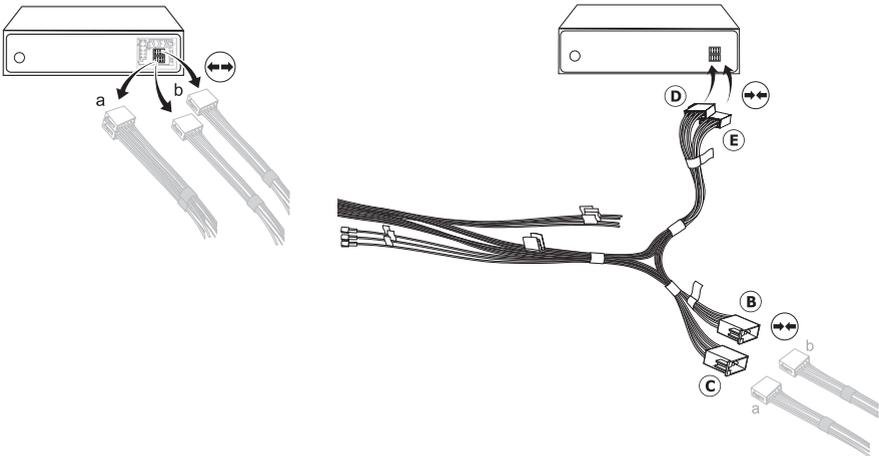
Möchten Sie die Musik oder die Sprache über die vier LINE-Kabel übertragen, dann sind diese entsprechend an das jeweilige Radio und dessen Anschlüsse (PHONE-IN bzw. AUX-IN) zu adaptieren. Entsprechende Adapter sind im Fachhandel erhältlich.
